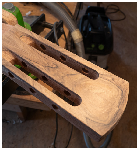
Bohrungen und Schlitzte in der Kopfplatte werden für die Mechaniken genau herausgearbeitet.
