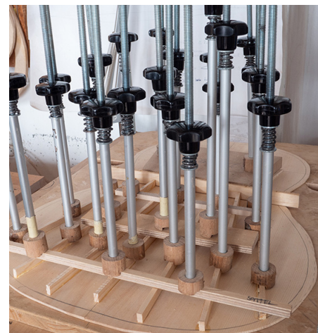
Sowohl der Boden als auch die Decke werden mit stabilisierende Balken verstärkt. Das sogenannten Himmelbett sorgt für eine feste Verleimung.
