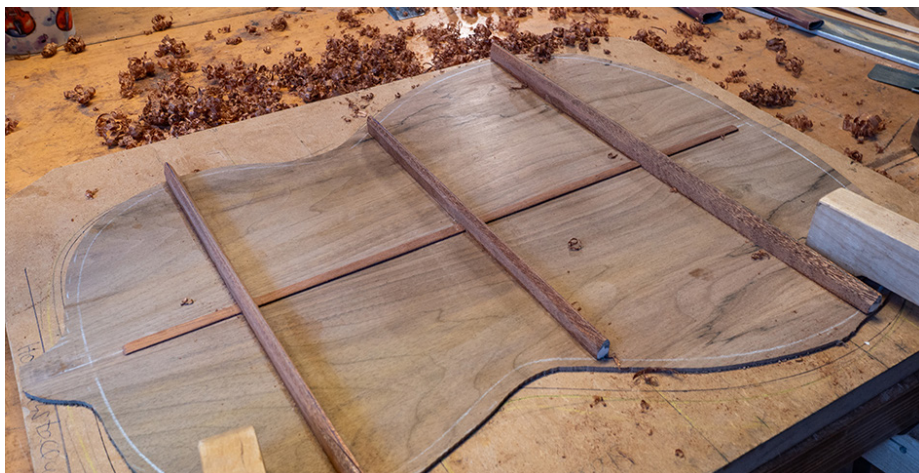
Sowohl der Boden als auch die Decke werden mit stabilisierende Balken verstärkt. Das sogenannten Himmelbett sorgt für eine feste Verleimung.
