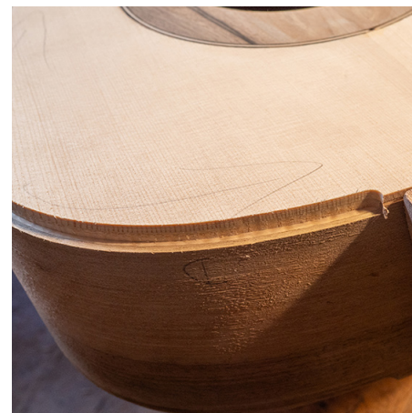
Die Ränder des Korpus werden ausgefräst, um Platz für die Randstreifen zu schaffen.
